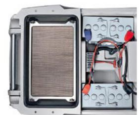
Werkzeugloser Filterzugang aufgrund wartungsfreundlicher Konstruktion (Sweep CS 60 AB / Hybrid).
